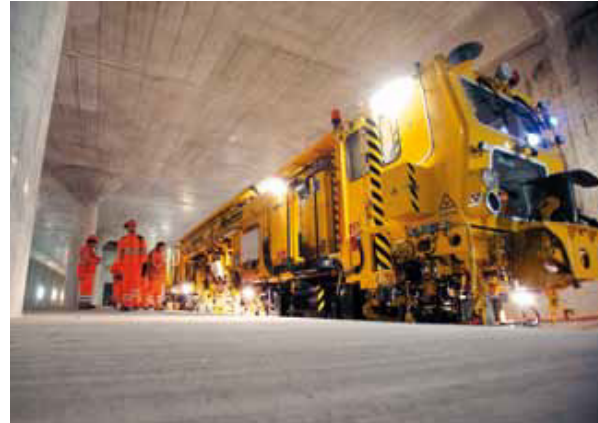
Maschinelle Stopfarbeiten des Schotters im Bereich der Haltestelle Luzern Allmend/Messe.
